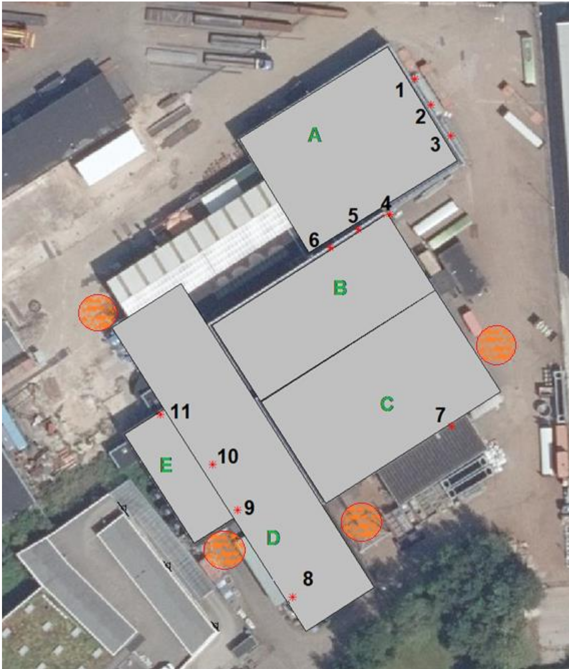
Figuur 2.2. Steelcare – Emissiepunten, aangegeven met cijfers. Tevens locaties van potentiële diffuse emissies door geopende deuren aangegeven met oranje cirkels. Posities tijdens bedrijfsbezoek geïnventariseerd en teruggekoppeld met Steelcare.
